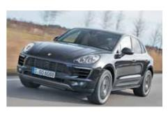
Есть система помощи при трогании в гору и спуске с нее. Причем скорость спуска можно регулировать - от 3 до 30 км/ч. А если включить внедорожный режим, то автоматика поднимет подвеску в верхнее положение (до 230 мм) и будет ее удерживать, пока скорость вашего передвижения не превысит 80 км/ч. Правда, это в том случае, если вы остановите выбор на пневматической подвеске.
