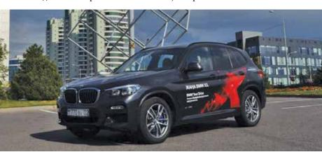
Светодиодная оптика, крупные классические «ноздри», изгиб Хоффмайстера, шестиугольные противотуманки... Последние, кстати, ХЗ получил первым – все остальные уже лишь повторяют. А, учитывая, что автомобиль переехал на новую платформу CLAR (с традиционной двухрычажкой спереди и оригинальной пятирычажной подвеской сзади), он подрос и в размерах. Длина увеличилась на 51 мм, ширина – на 10 мм, высота же, считай, что
